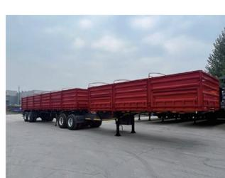
В отличие от обычных полуприцепов с боковой разгрузкой, самосвальный автопоезд состоит из двух или более полуприцепов с боковой разгрузкой, соединенных вместе, поэтому он может вместить большое количество груза.
